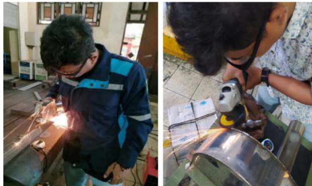
Gambar 5. Proses pemotongan dan penggerindaan mesin
