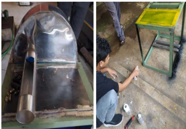
Gambar 8. Pembuatan penutup pisau pengiris singkong dan proses pengecatan
