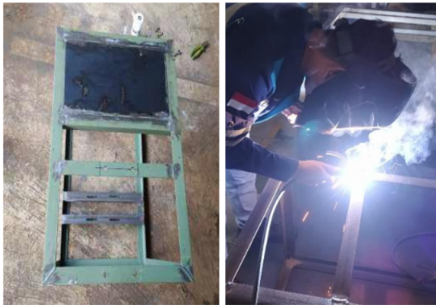
Gambar 7. Proses pembuatan rangka mesin pengiris singkong
