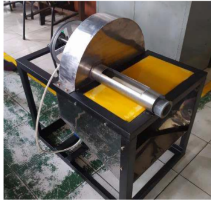
Gambar 9. Mesin pengiris singkong yang sudah digabungkan komponen-komponennya.
