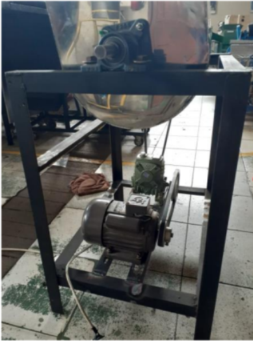
Gambar 3. Proses fabrikasi mesin pengaduk isi adonan bakpia
