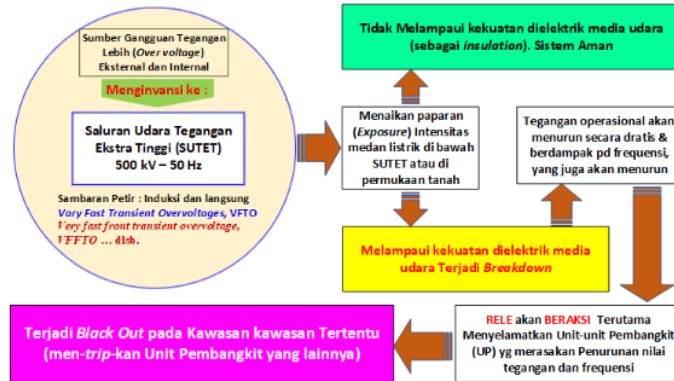
Gambar 3. Proses Keterjadian Black-Out untuk Kasus Kegagalan Insulation Media Udara pada SUTET-500 kV, 50 Hz, Span 434 – 435 Dusun Malon, Ds. Gunung pati, Kecamatan Gunung pati – Kota Semarang
