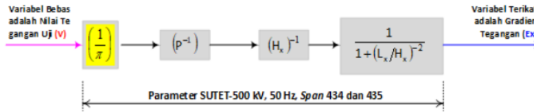
Gambar 8. Hubungan antara Variabel Tegangan Uji (V) dan Variabel Gradien tegangan / Medan listrik yang diamati (Ex)
