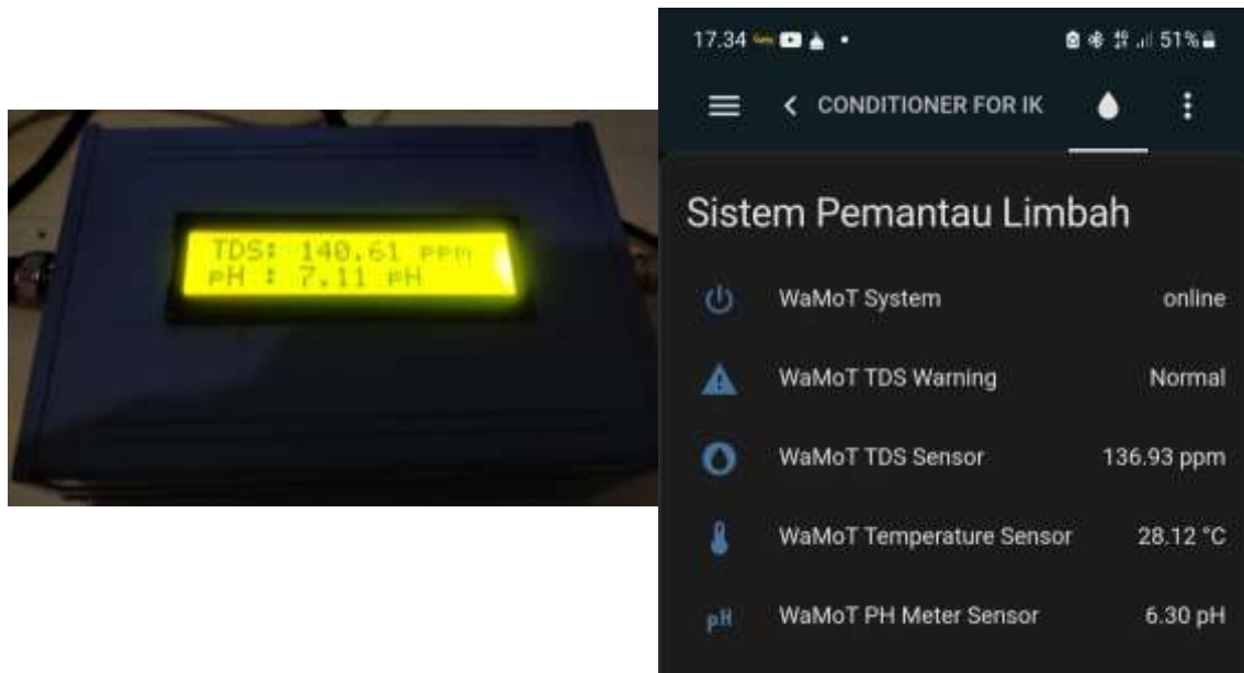
Gambar 4. Alat sistem pemantauan (kiri: tampilan LCD alat, kanan: tampilan dari aplikasi)
