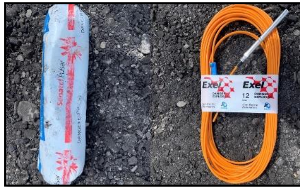
Gambar 4. 5 Dynamit dan In Hole Delay
