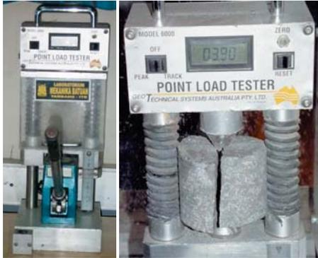
**Gambar 3.11.** Peralatan untuk *point load test*
