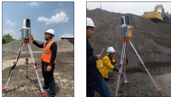
Gambar 4.14. Pengukuran menggunakan TLS
