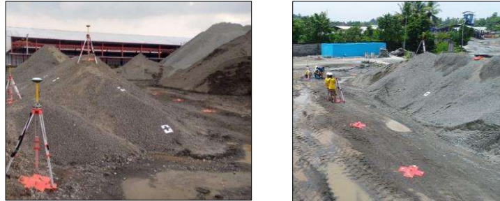
Gambar 4.3. Pengukuran GCP dengan GPS Geodetic metode static
