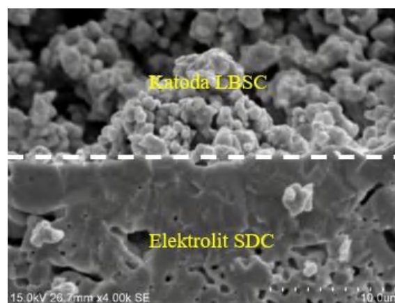
Gambar 5. Penampang sel simeteris yang diamati menggunakan SEM
