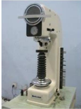
**Gambar 3.7** Alat uji kekerasan *Vickers*
