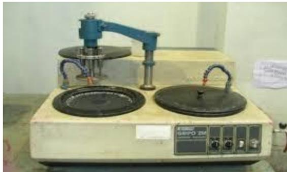
**Gambar 3.5** Mesin pengamplasan
