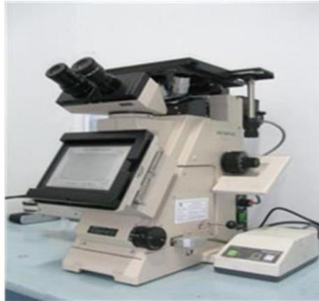
**Gambar 3.6** Alat uji struktur mikro (mikroskopik optik)
