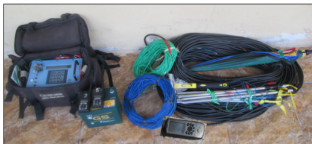
Gambar 3. Peralatan utama dan pendukung untuk melakukan pengukuran VES di lapangan
