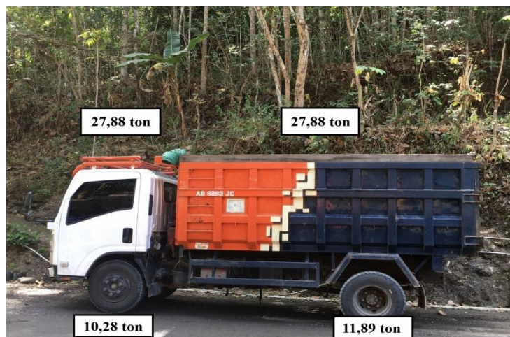
Gambar D.1 Distribusi Beban Truk Pada Roda
