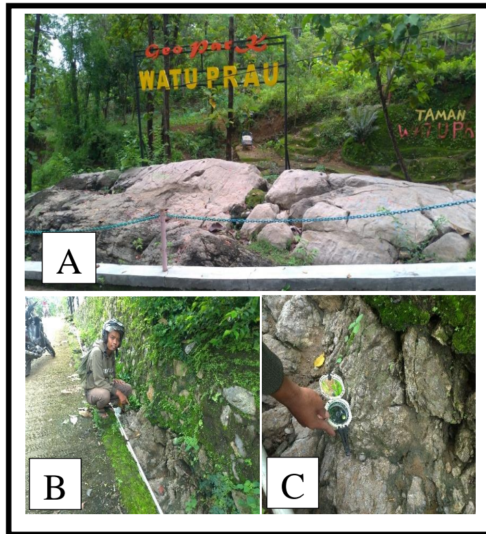
Gambar 4. 10 A-B Kenampakan ciri litologi Satuan Batugamping Nummulites yang menunjukkan kemiringan ke arah tenggara, C. Litologi dengan pembeding kompas pada LP 59
