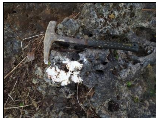
Gambar 5. Batugamping kristalin di lapangan menunjukkan adanya lubang akibat pelarutan batuan ( lapies ).
