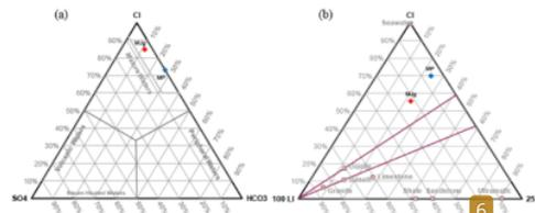
Gambar 4. Menunjukkan hasil pengeplotan persentase anion utama pada diagram segitiga Cl-SO<sub>4</sub>-HCO<sub>3</sub> (Giggenbach, 1988) (a) dan Diagram segitiga Cl-Li-B (Giggenbach, 1991a) (b) menunjukkan bahwa kedua mata air panas Pablengan (MP) dan Jegglong (MJG) didominasi oleh Cl
