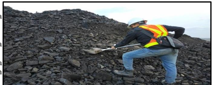
Gambar 3 Pengambilan Sampel *Seam 200* Di *Stockpile*
