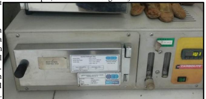
Gambar 15 MFS Oven Dalam Pengujian Total Moisture
