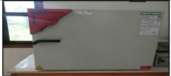
Gambar 13 Oven Balance Untuk Pengujian Ash Content Analysis of Volatile Matter
