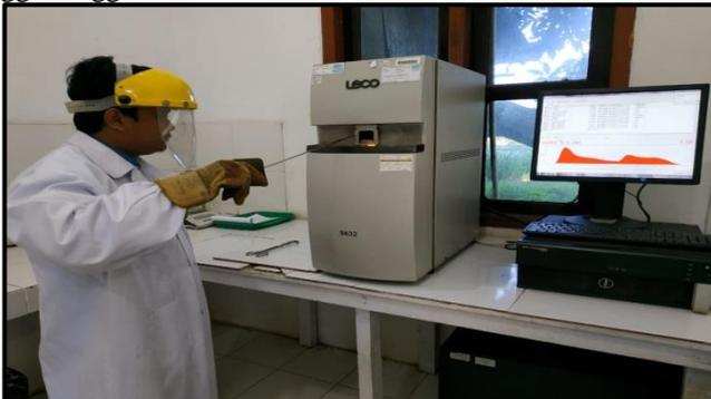
Gambar 17 Analisa Total Sulfur Menggunakan *Leco S632*
