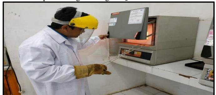
Gambar 14 Pengujian Volatile Matter
