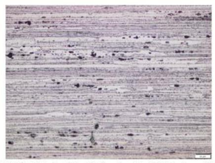
Foto Struktur Mikro daerah Base Metal spesimen Aging 190°C (Perbesaran 200X)
