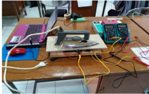
Gambar 9. Proses pengujian Thermoelectric Generator Al dan C
