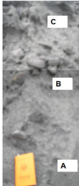
Gambar 4. Endapan piroklastik di sungai Gendol di Desa Kepuharjo, terdiri 3 lapisan yang berbeda.
