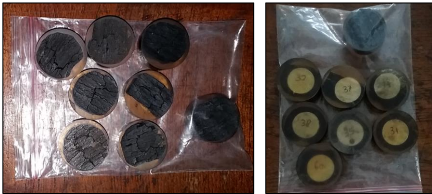
Gambar 2.2. Sayatan poles terhadap 8 sampel cleat batubara terdiri dari kode sampel 31 seam L ke dalaman 153,27 m, kode sampel 30 seam N ke dalaman 228,40 m, kode sampel 34 seam O ke dalaman 261,15 m, kode sampel 32 seam O ke dalaman 262,30 m, kode sampel 35 seam O ke dalaman 262,85 m, kode sampel 37 seam O ke dalaman 264,20 m, kode sampel 38 seam O ke dalaman 264,75 m, dan kode sampel 60 seam P ke dalaman 265,30 m.
