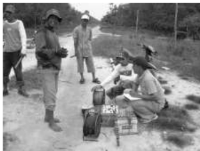
Gambar 5. Peralatan resistivimeter dan pengambilan data di lapangan
