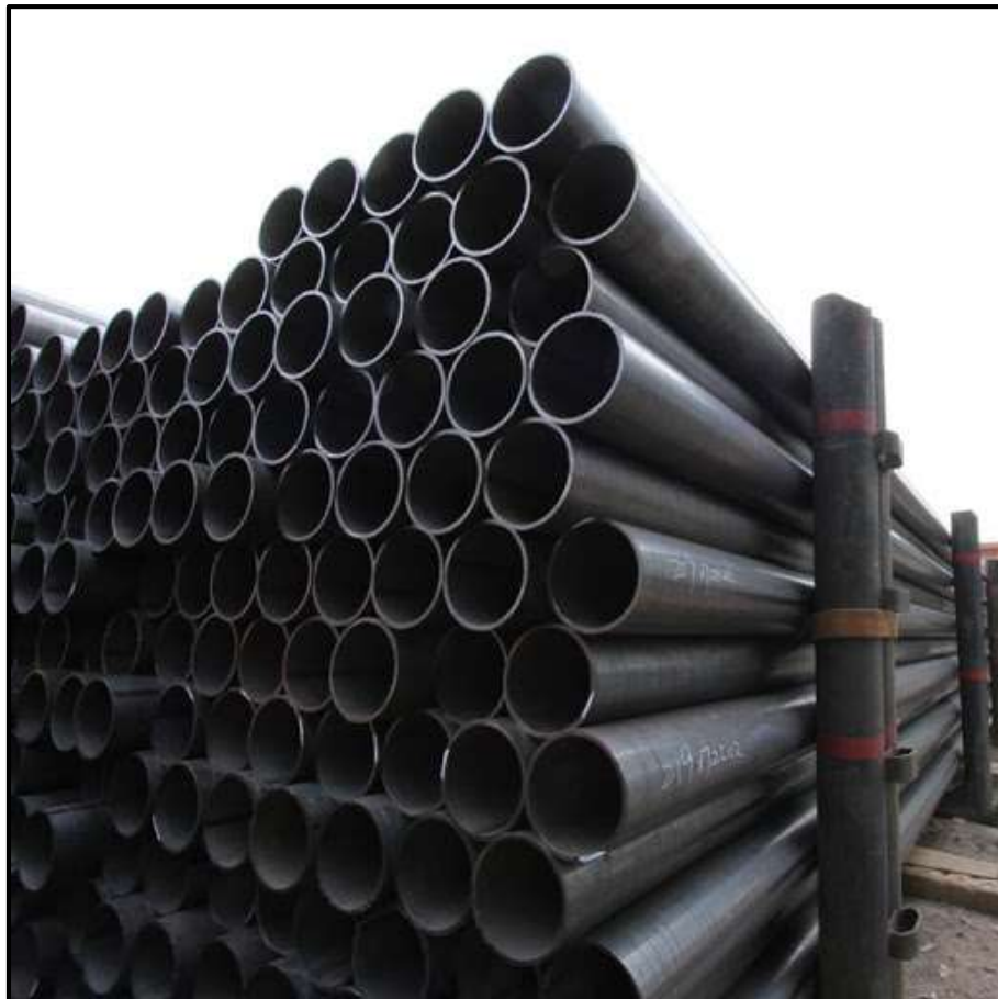
Gambar 3. 1. Pipa baja dengan NPS 2 in schedule 40
