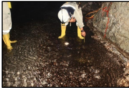
Gambar 2. Pengambilan Data Debit Air
