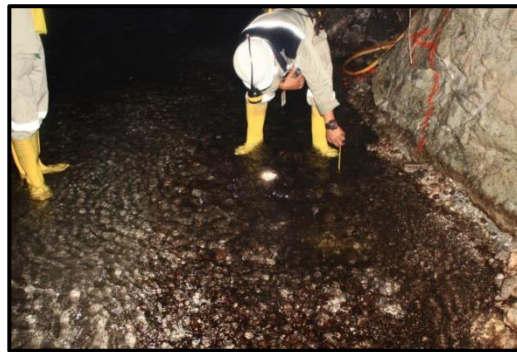
Gambar 2. Pengambilan Data Debit Air
