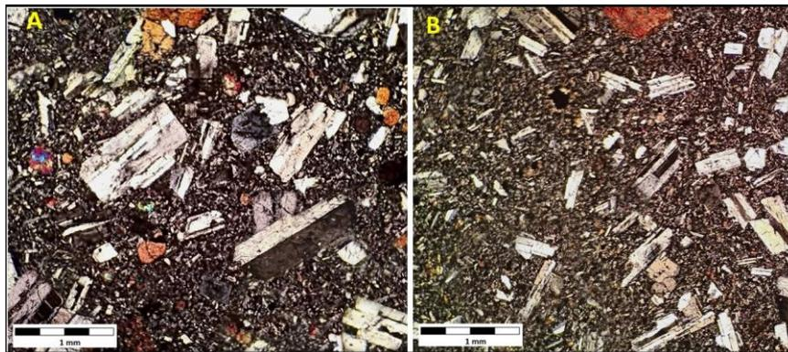
**Gambar 5.** Kenampakan petrografi yang diambil pada lava (lokasi C20) menunjukkan adanya tekstur *pilotaxitic* dengan nama batuan *pilotaxitic piroxene andesite* (A) dan kenampakan petrografi yang diambil pada bongkah (lokasi C22) dengan nama batuan *piroxene andesite* (B).
