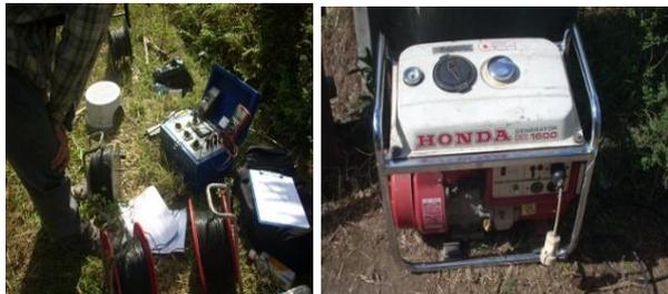
**Gambar 3.** Peralatan geolistrik yang digunakan dalam penelitian
