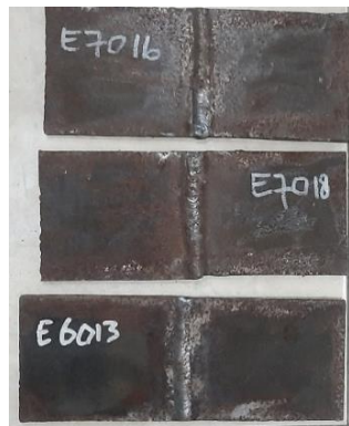
Gambar 2. Spesimen hasil pengelasan
