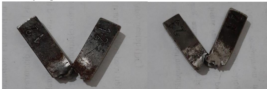
Gambar 22. Spesimen hasil uji impact elektroda E6013
