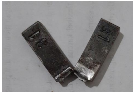
Gambar 24. Spesimen hasil uji impact elektroda E7018
