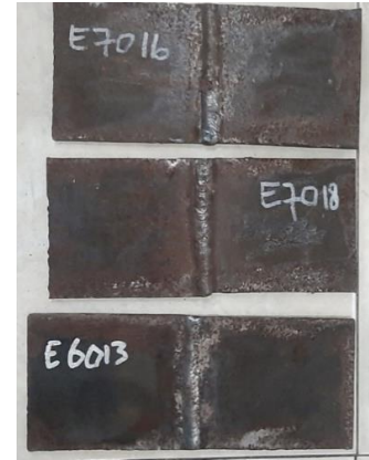
Gambar 4. Strip plate setelah dilas
