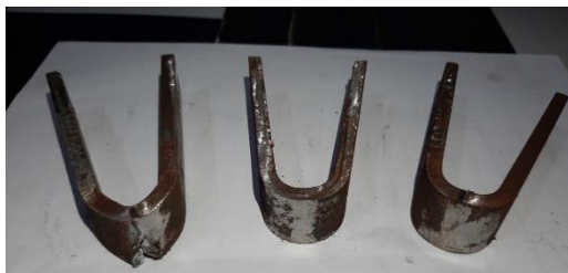
Gambar 18. Spesimen hasil uji bending elektroda E6013
