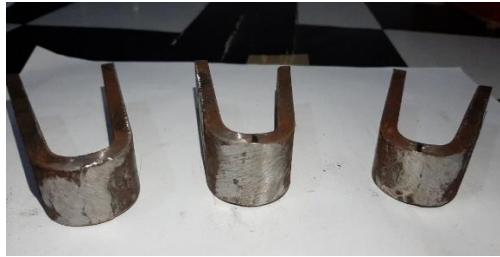
Gambar 20. Spesimen uji bending elektroda E7018
