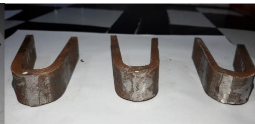
Gambar 19. Spesimen uji bending elektroda E7016
