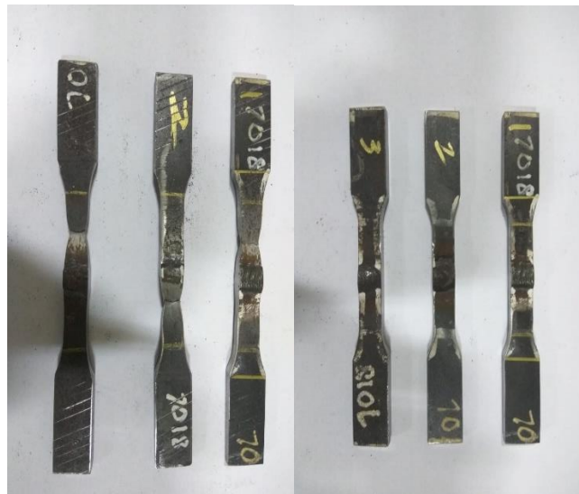
Gambar 4.32. Spesimen uji tarik elektroda E7018 sebelum dan sesudah diuji.
