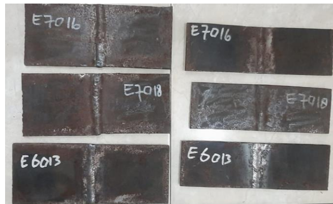
Gambar 8. Strip plate setelah dilas
