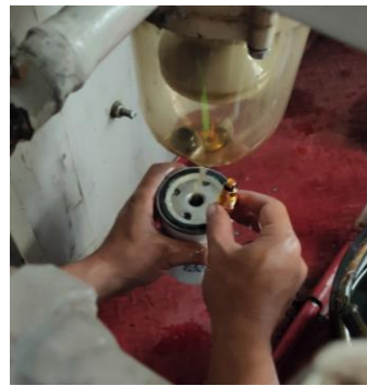
Gambar 1. 13 Mengisi Bahan Bakar Pada Main Filter Sebelum Dipasang
