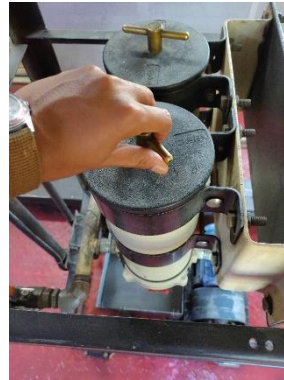
Gambar 1. 6 Membuka Tutup Rumah Fuel Filter Sparator
