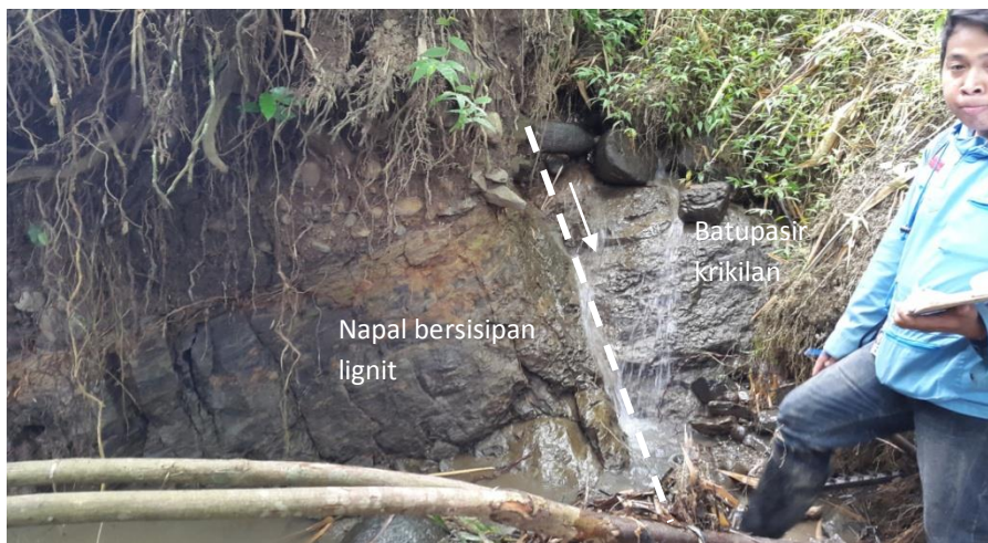
Gambar 5. Sesar Kali Watupuru 2 (LP 22) berupa sesar turun, dengan arah bidang sesar adalah 71^{\circ}/N316^{\circ}E , yang memisahkan napal bersisipan lignit dengan batupasir krikilan
