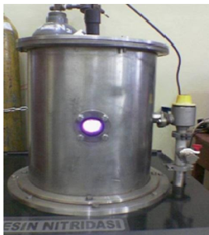
Gambar 1. Foto tabung reaktor plasma mesin nitridasi di PTAPB-BATAN Yogyakarta
