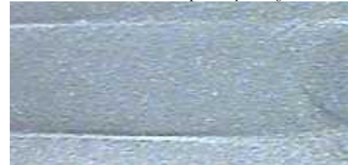
b. Visual FSW dengan shot peening
