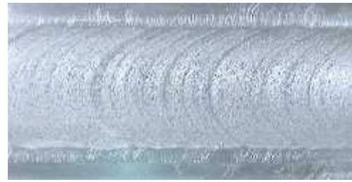
a. Visual FSW tanpa shot peening
