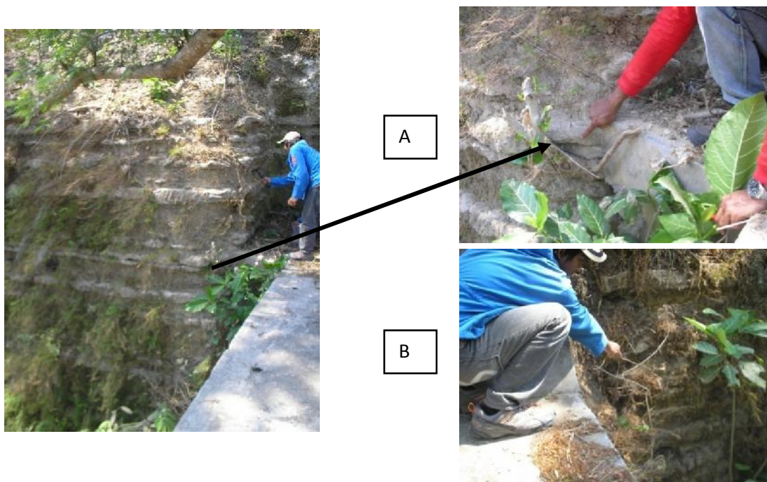
Gambar 4. Offset perlapisan batugamping di daerah Guluhredjo: A) posisi key bed di sisi utara selokan, B) posisi key bed di sisi selatan yang berada di bawah dinding bendung.
