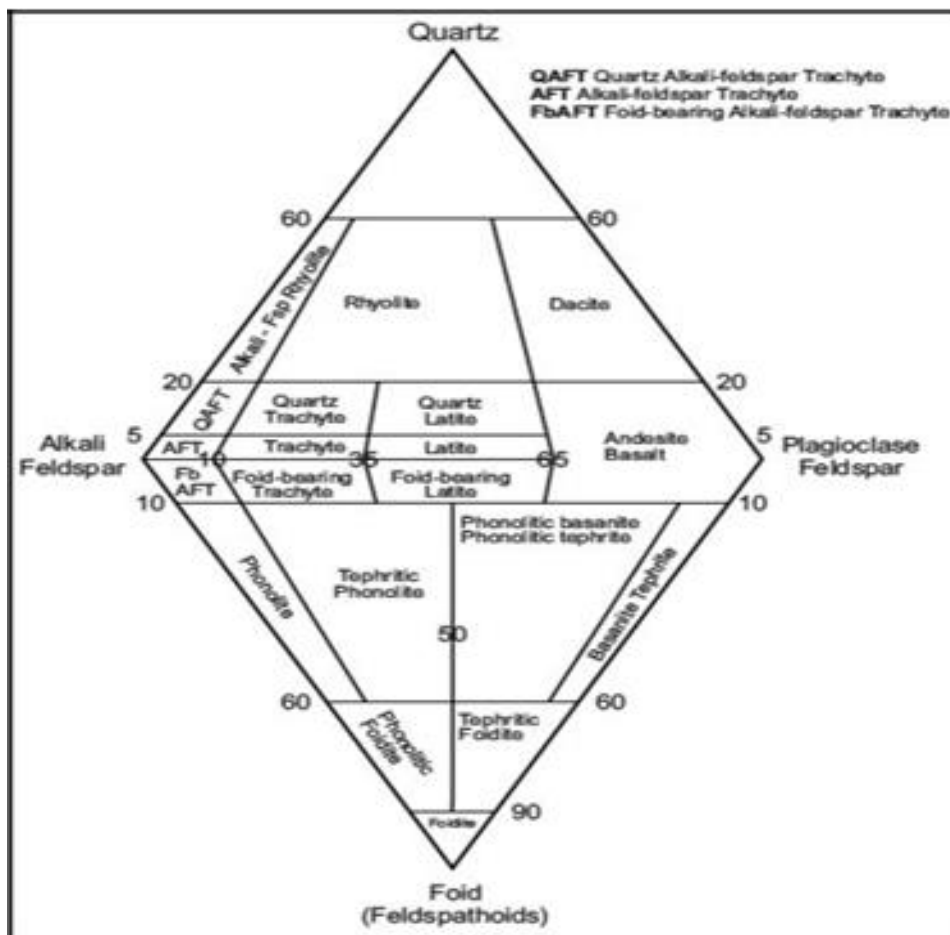
Gambar 2.5. Klasifikasi batuan beku berdasarkan pada kehadiran mineral felsik menggunakan diagram QAPF, dimana kehadiran mineral mafik kurang dari 90% (Streckeisen, 1976).
